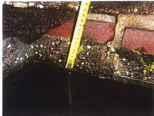
Foto 6: eindstand beproeving na 2 e keer 60 minuten : 30 mm lekverlies
